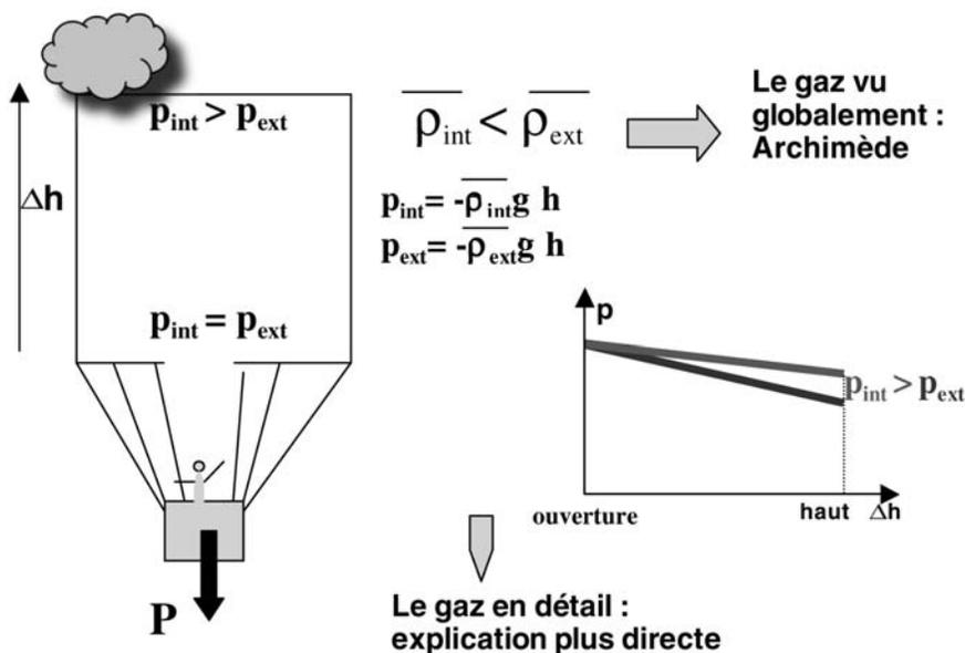
Figure 8 • Éléments pour comprendre la sustentation d'une montgolfière
