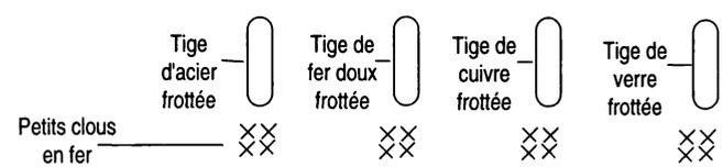
**Expérience 3 :** Nous frottons l'une des extrémités d'une nouvelle tige en acier avec l'aimant et nous approchons l'autre extrémité des petits clous en fer.
